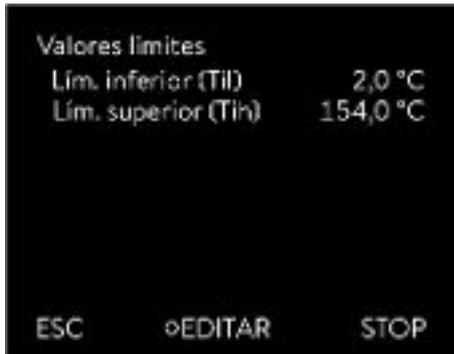
Fig. 47: Fijar los valores límites de temperatura
