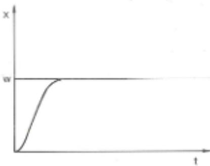
Fig. 61: Ajuste óptimo
