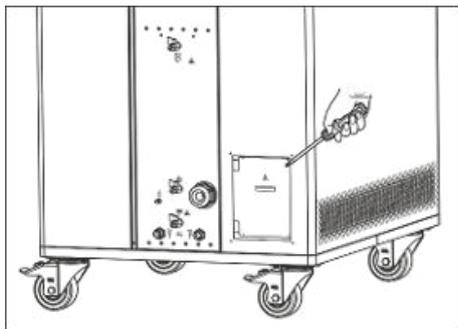
Fig. 23: Tapa de la caja de conexiones
