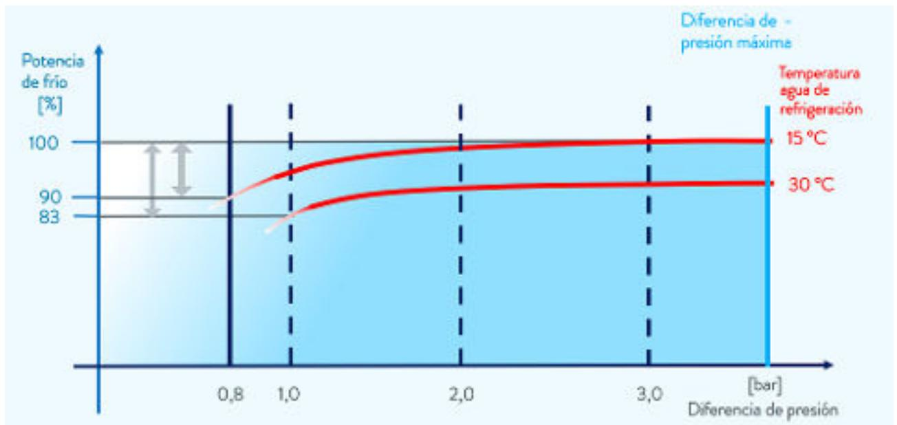
Fig. 90: Diferencia de presión del agua de refrigeración
