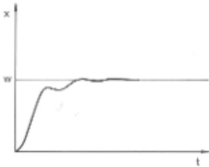
Fig. 63: Parámetro de regulación  $X_p$  demasiado bajo
