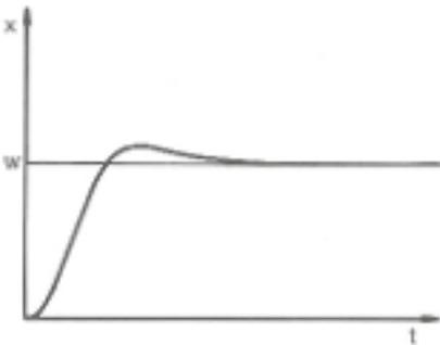
Fig. 62: Parámetro de regulación  $X_p$  demasiado alto
